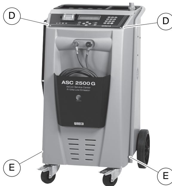
3. Gefäß, ausreichend für mindestens ½ Liter, unter das AirConServiceCenter stellen. Das Öl aus der Vakuumpumpe fließt beim Ablassen durch die Öffnung (I) im Boden des Geräts.
