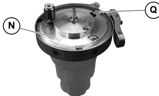
5. Altölbehälter am Schnellverschluss aufstecken.
