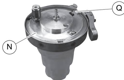
5. Altölbehälter am Schnellverschluss aufstecken.
