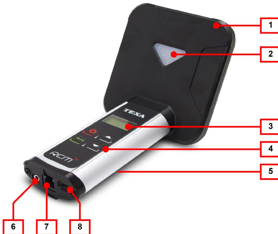
1. **Sensor:** ermöglicht die Entdeckung der Motordrehzahl.
