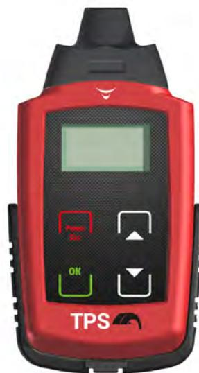
**TYRE PRESSURE SYSTEM (TPS)** ist ein Diagnosegerät, das eigens für die Wartung der Sensoren des **TPMS** Systems realisiert wurde, und insbesondere für den Austausch des Sensors in den Reifenventilen.
