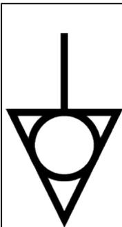
**Dieses Symbol zeigt an, dass die Außenleiter der BNC-Steckverbinder die gleiche Spannung haben (miteinander kurzgeschlossen).**
