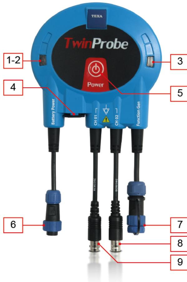
1. **GRÜNE LED:** Zeigt an, dass das Gerät eingeschaltet ist.
