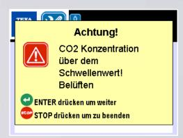
Die TEXA Software warnt den Anwender, wenn aufgrund des Ablassens von CO2 aus der Anlage die Arbeitsumgebung nicht mehr sicher ist.
