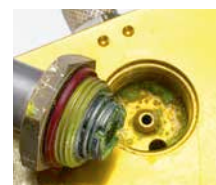
Auswirkung des Dicht- mittels in dem Klimaservice- gerät ohne Verwendung des Recycle Guards
