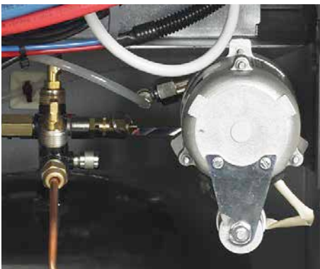
Integrierte Flüssigkeitspumpe: Zum Befüllen großvolumiger Klimaanlage
